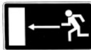
Richtungsangabe links für Rettungsweg
