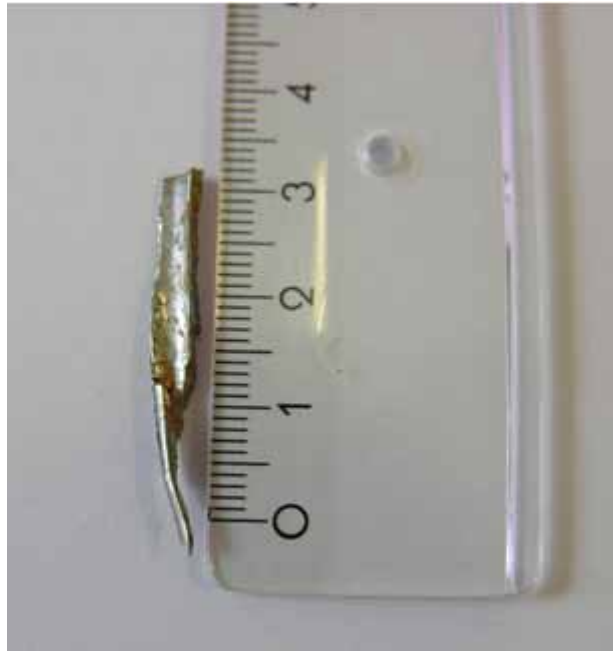
Abb. Metallsplitter aus Pizzatomaten
