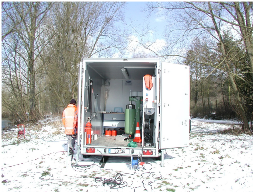
Abb. 2-1: Durchlaufzentrifuge des LUA des Saarlandes
