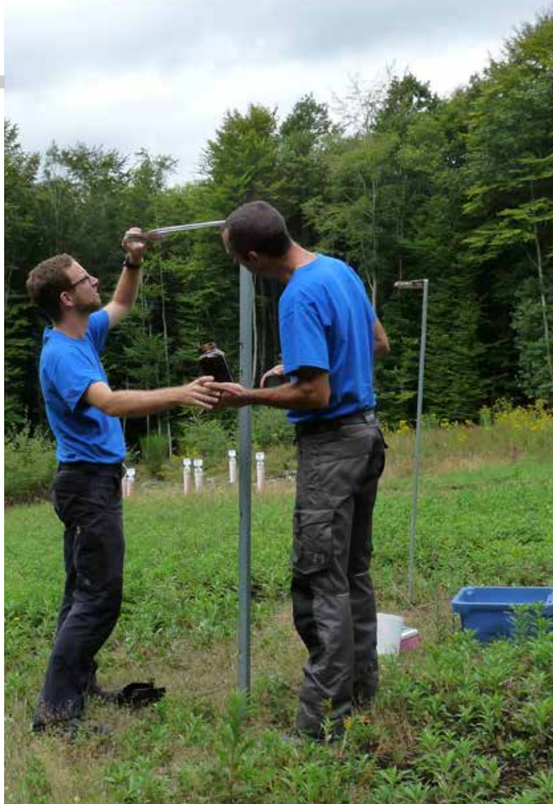
Passivsammlersystem zum Messen von Luftschadstoffen an der saarländischen Station Fischbach
