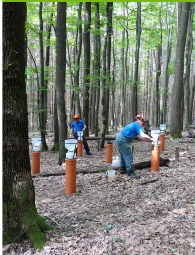
Probenahme an einer Depositionsmesstation
