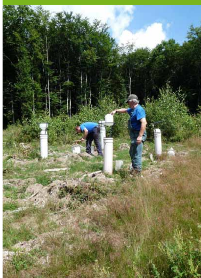
Probenahme an einer Freiland-Depositionsmessstation
