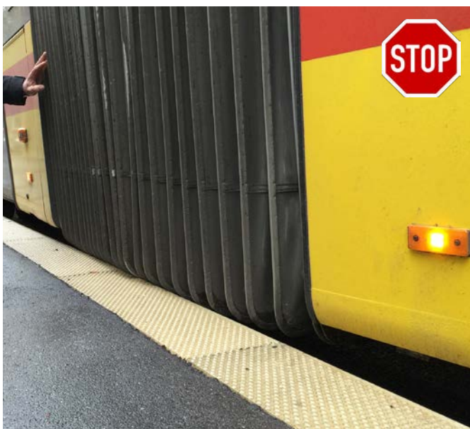
Bild 39: Über den Wagenkasten hinausreichender Faltenbalg an einer hohen Haltekante [Foto: Boenke]
