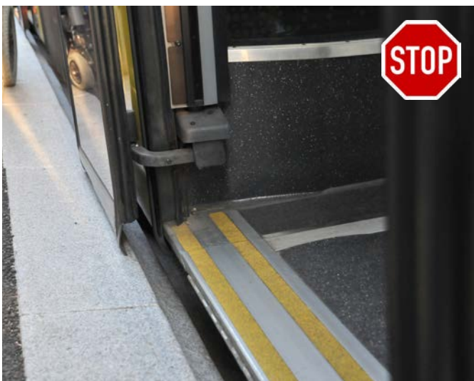
Bild 37: Lange Türdichtungen an der Unterseite von Schwenkschiebetüren können auf hohen Plattformen aufsetzen [Foto: Stocker Arnet]
