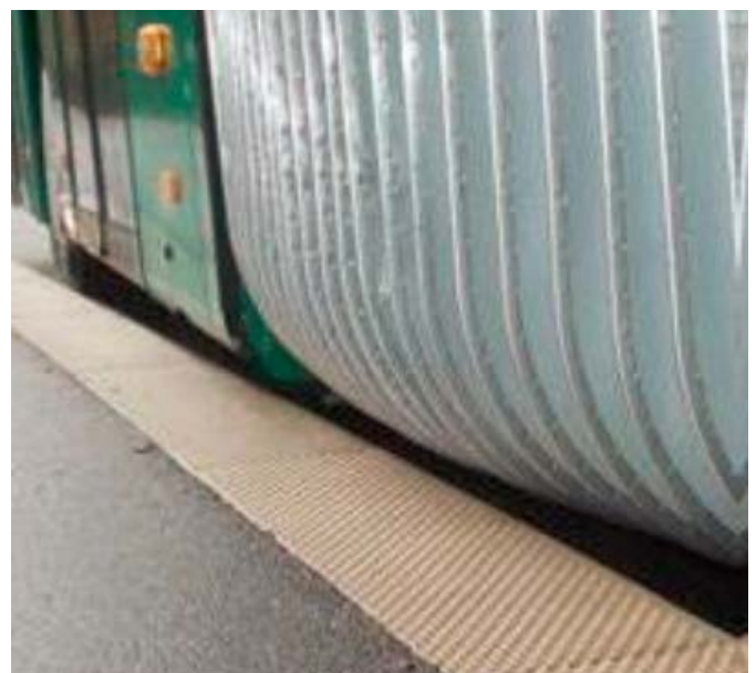
Bild 40: Abgerundeter Faltenbalg für Anfahrt an hohe Haltekanten [Foto: Stocker-Arnet]
