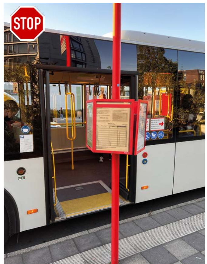
Bild 18: Ungünstig platzierter Haltestellenmast, der den Fahrgastwechsel stört und den Einsatz der Klapprampe behindert [Foto: Boenke]
