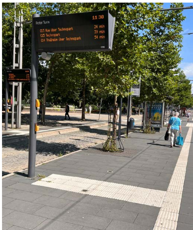
Bild 32: Beispiel für einen Dynamischen Fahrgastinformationsanzeiger mit Anforderungstaster für Vorlesefunktion und Auffindestreifen [Foto: Boenke]
