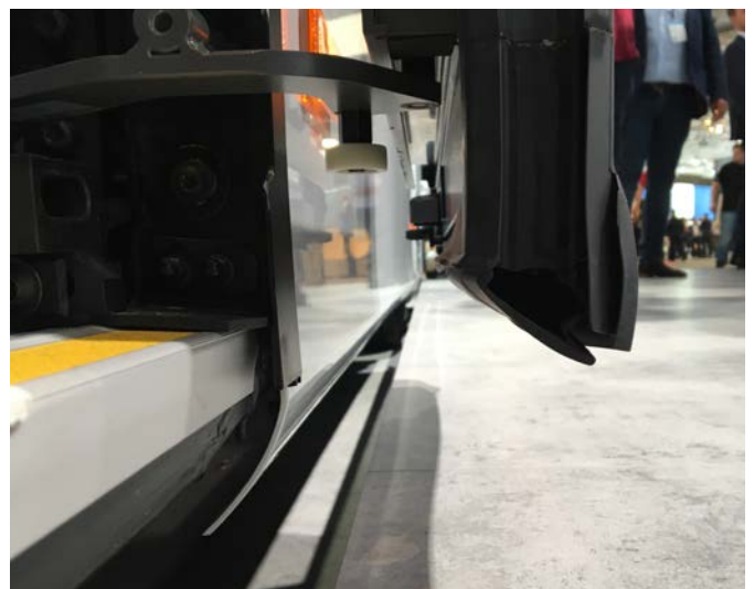
Bild 38: Schwenkschiebetüren werden mit modifizierten Türdichtungen angeboten, um beim Öffnen Berührungen mit hohen Haltestellenplattformen zu vermeiden [Foto: Stocker Arnet]
