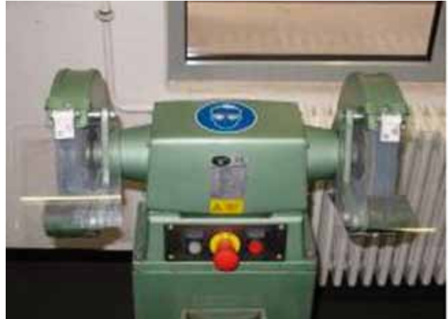
Schleifmaschine, Schutzbrille tragen! Schutzeinrichtung: Plexiglasabdeckung der Schleifsteine, Notausschalter
