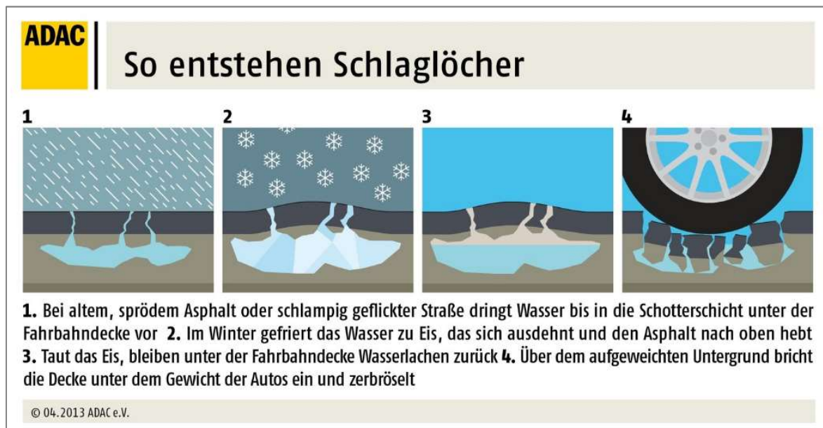
Abbildung 3: Entstehung von Schlaglöchern (Quelle: ADAC)
