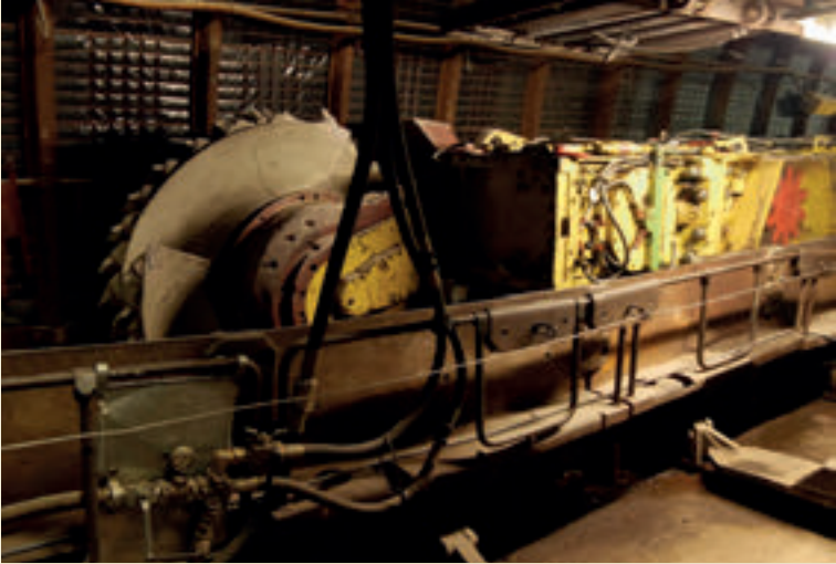
Walzenschrämlader der Firma Eickhoff, seit etwa 1990 in Nutzung, Foto: 2018
