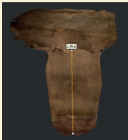
3 Ausschnitt aus dem 3D-Modell, das Gesenk mit dem oberhalb anschließenden Stoß des Abbaurums. Gut zu erkennen ist die mit der wasserführenden Schicht einhergehende Farbänderung im unteren Bereich des Gesenks, Abbildung: N. Schimerl, 2019
