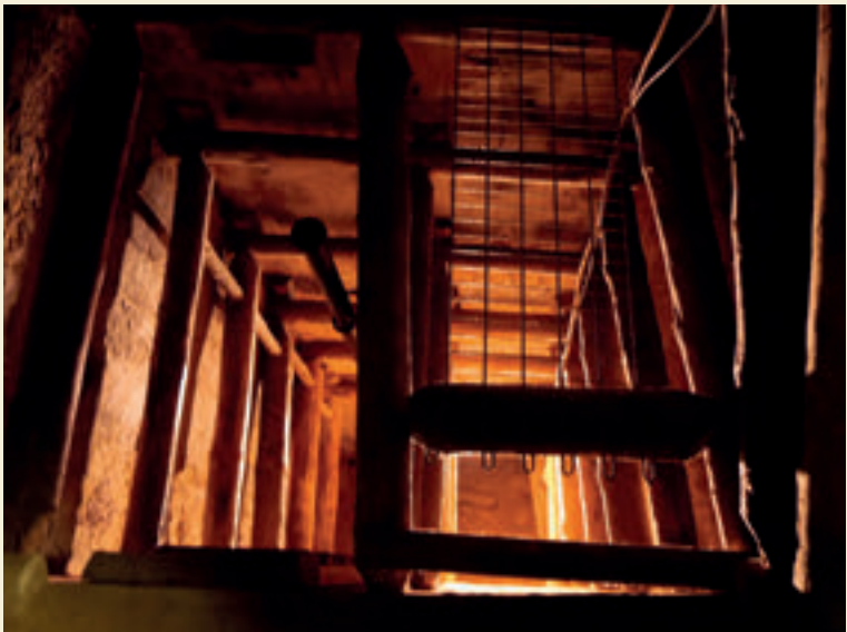
Kammerstreb mit Holzausbau, Foto: 2018
