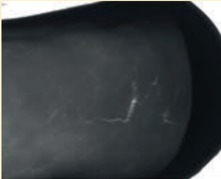
1 Reinheim, spätbronzezeitlicher Hortfund. Röntgenbild mit Detail des Bronzearmrings. Zu sehen sind sowohl die Verzierungen des Armrings als auch Risse und Fehlstellen im Material, Aufnahme: S. Heyne, 2019
