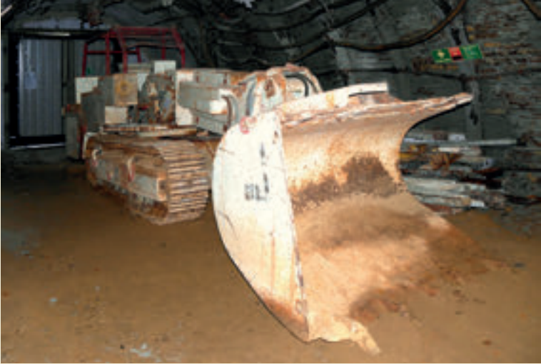
Seitenkipplader der Firma Deilmann Haniel, Baujahr um 1980, Foto: 2018
