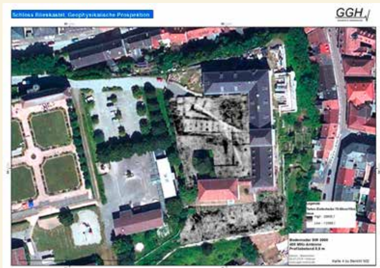
2 Geoprospektion 2016: Das Bodenradar zeigte Baubefunde vom Schloss und der Burg Blieskastel, die heute unter dem Rasen des Schulhofs liegen. Tiefenscheibe 70-90 cm, projiziert auf das Luftbild des Schlossbergs, Quelle: C. Hübner, GGH GmbH / World Imagery Sources: Esri, DigitalGlobe, GeoEye, i-cubed, USDA FSA, USGS, AEX, Getmapping, Aerogrid, IGN, IGP, swisstopo, and the GIS User Community
