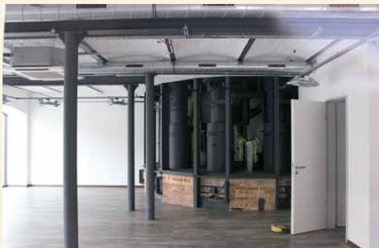
Wadgassen, Cristallerie: Unterbau eines Glasofens im Erdgeschoss, Foto: 2013
