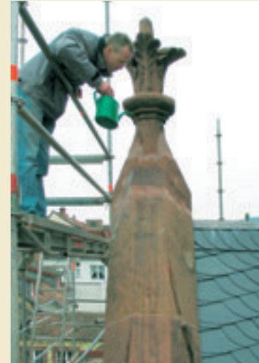
Merzig, Evangelische Kirche, Benetzungssprobe an einer Kreuzblume. Foto: 2006
