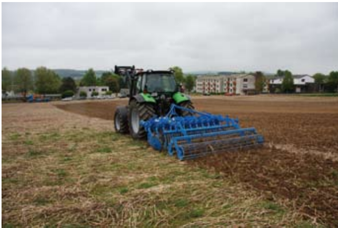
Abb.7: Durch Grubbern wird der Boden nur oberflächlich gelockert. Pflanzenreste nehmen als „Knautschzone“ die Energie von Niederschlägen auf
