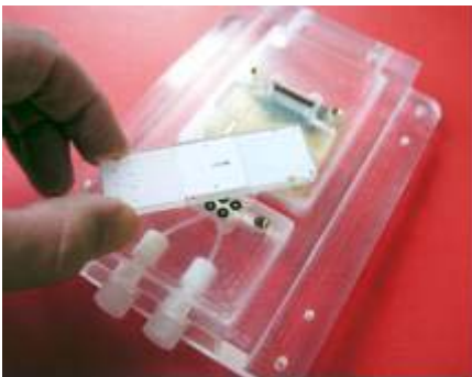
Einwegkartusche mit integriertem, vom Fraunhofer IBMT gekapselten Biochip. Foto: Fraunhofer IBMT
