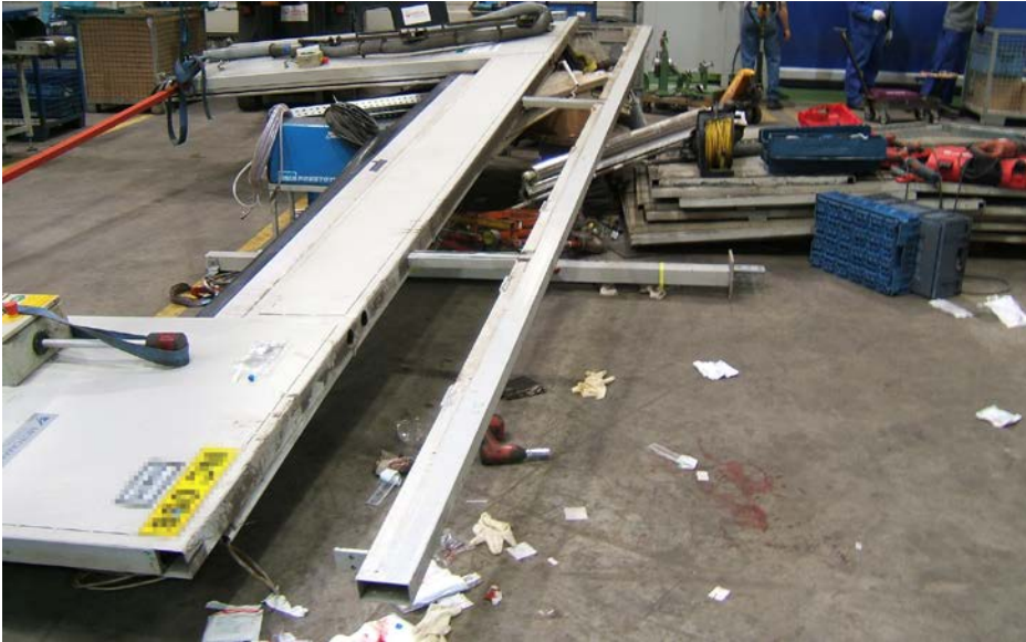
Bild 1 Umstürzendes Wandelement verletzte zwei Beschäftigte
