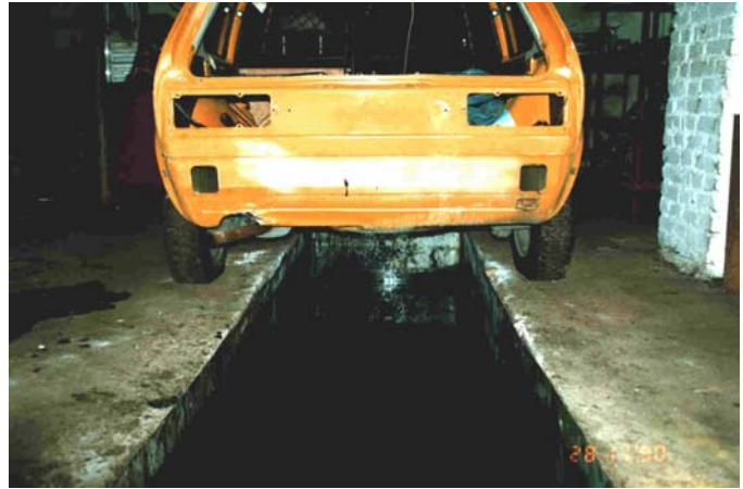
Abbildung 17 Zweckentfremdete mit Altöl gefüllte Ölwechselgrube
