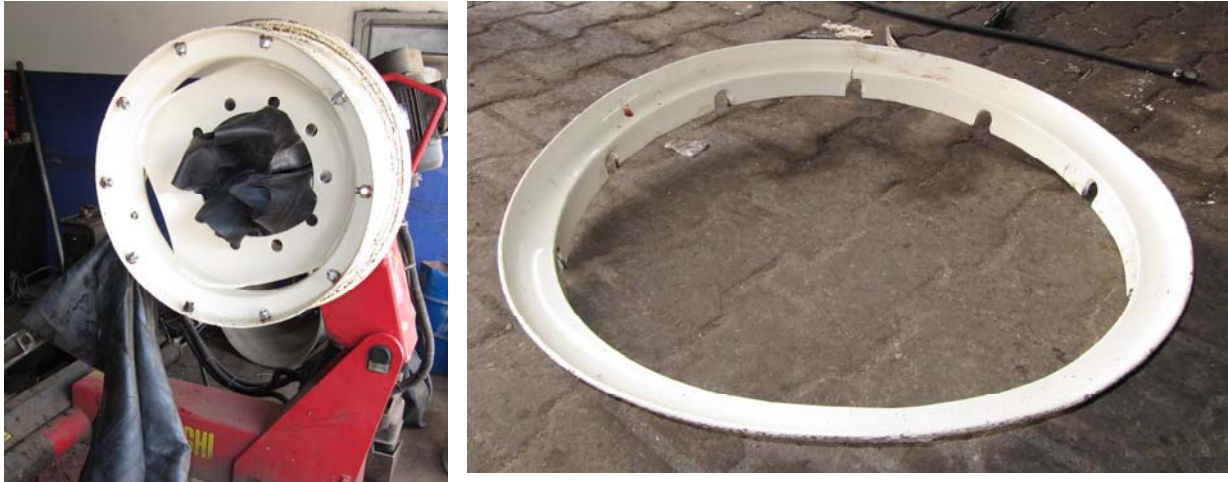
Abbildung 1: Montagemaschine mit Felgenteil und abgesprungener Felgenring
