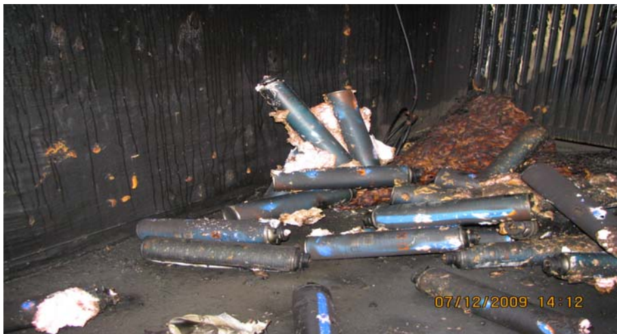
Abbildung 3: Aufgeplatzte Kartuschen nach der Explosion
